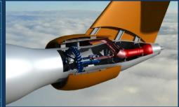
e) The fuselage fan gear system
